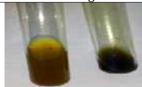
Fig 1. Muestra la determinación cualitativa de flavonoides con la prueba de hidróxido de sodio obteniendo positivo (izquierda) al virar la coloración de verde (derecha) a Amarillo-Naranja.
