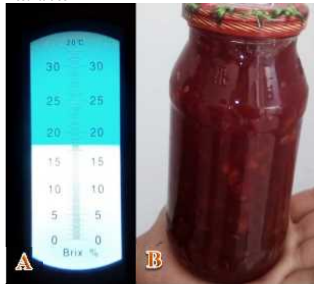
Fig. 1. A) representa la cuantificación de azúcares presentes 18 °Brix, mientras que B) se aprecia el producto de color rojizo, homogéneo y con una adecuada viscosidad.
